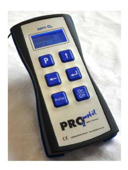
키보드는 아주 튼튼한 특수 스냅 돔 (snap dome film) 필름이다. 안정된 합성 판 (synthetic-plates)이 폴리카보네이트와 도체 라인 사이에 부착되어 있다. 이는 용접 또는 작업 장갑을 착용한 오퍼레이터에게 압력을 가하는 작용을 한다. 버튼을 클릭하면 신호음이 발생한다. 또한 실용적인 소프트웨어가 사용자에게 몇가지 정보를 제공한다.
